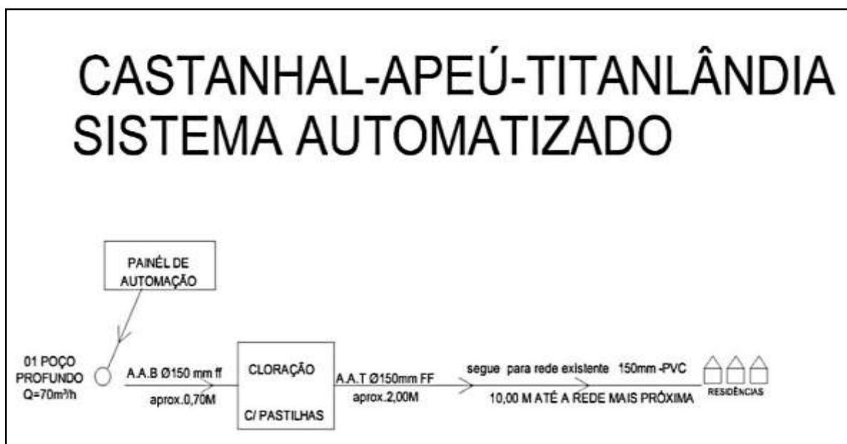
Figura 42 – Fluxograma de captação e distribuição de água – APEÚ - TITANLÂNDIA.
