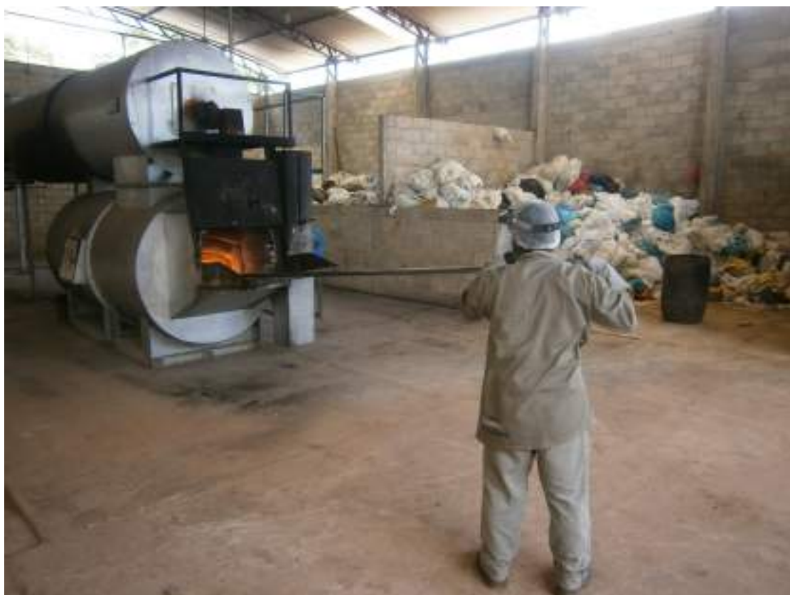
Imagem 147: Operação da Fornalha
